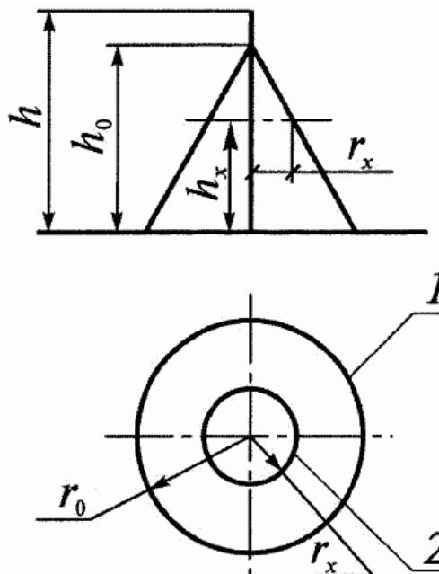
Рисунок 7. Схема зоны защиты одиночного стержневого молниеводителя: 1, 2 - границы зоны защиты на уровнях соответственно земли и высоты защищаемого сооружения
