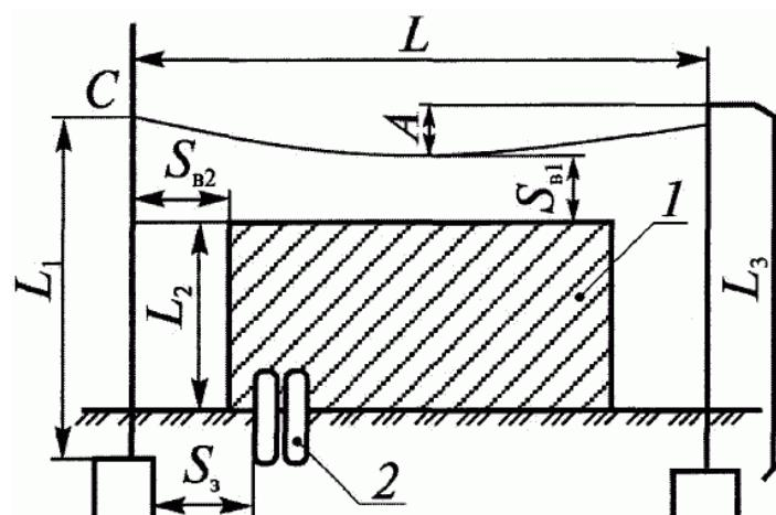
Рисунок 2. Отдельно стоящий тросовый молниеотвод: L - расстояние между молниеотводами;  $L_1$ ,  $L_3$  - протяженность токопроводов;  $L_2$  - высота защищаемого сооружения;  $S_{B1}$ ,  $S_{B2}$  - наименьшие допустимые расстояния от тросового молниеотвода соответственно в точках А и С до защищаемого сооружения;  $S_3$  - наименьшее допустимое расстояние от заземления до металлических коммуникаций; 1 - защищаемое сооружение; 2 - металлические коммуникации.
