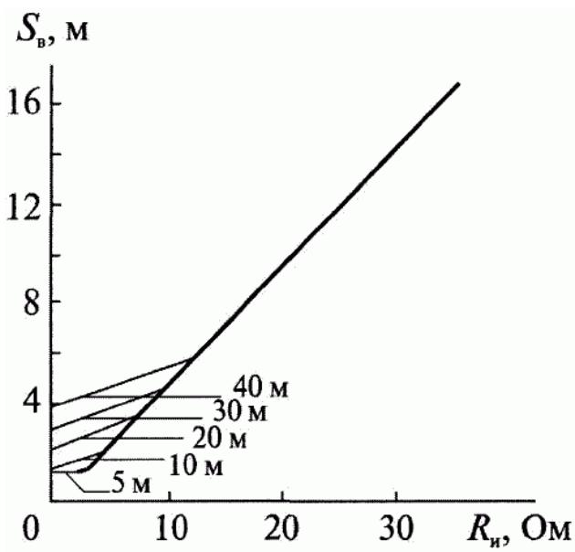
Рисунок 3. Наименьшие допустимые расстояния от стержневого молниевода до защищаемого сооружения
