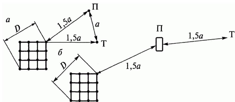
Рисунок 16. Двухлучевая (а) и однолучевая (б) схемы расположения электродов при измерении сопротивлений сложных заземлений и одночных горизонтальных полос:
