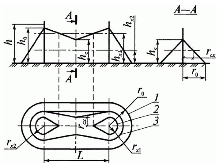
Рисунок 8. Схема зоны защиты двойного стержневого молниеводителя: 1, 2, 3 - границы зоны защиты на уровнях соответственно земли и высоты защищаемого сооружения
