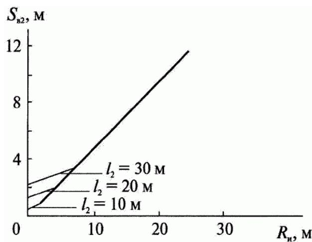
Рисунок 5. Наименьшие допустимые расстояния от молниевода до защищаемого сооружения
