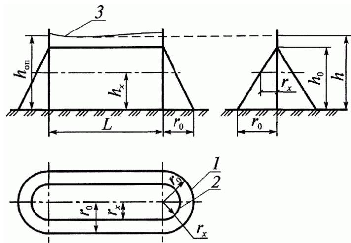
Рисунок 11. Схема зоны защиты одиночного тросового молниепомехи: 1, 2 - границы зон защиты на уровнях соответственно земли и высоты защищаемого сооружения; 3 - трос
