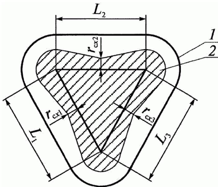
Рисунок 10. Схема зоны защиты (в плане) многократного стержневого молниевода: L1, L2, L3 - расстояния между молниеводами; 1, 2 - границы зон защиты на уровнях соответственно земли и высоты защищаемого сооружения
