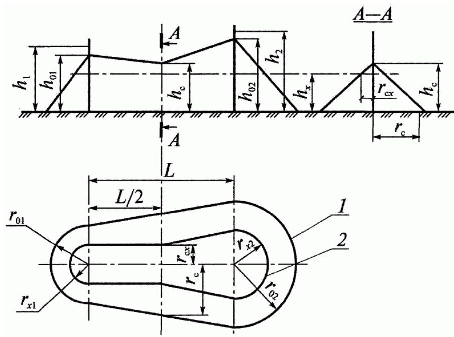
Рисунок 9. Схема зоны защиты двух стержневых молниеводов разной высоты: 1, 2 - границы зон защиты на уровнях соответственно земли и высоты защищаемого сооружения
