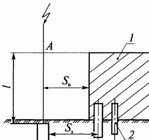
Рисунок 1. Отдельно стоящий стержневой молниеотвод: I - протяженность токопровода от точки А до заземлителя;  $S_B$  - наименьшее допустимое расстояние до защищаемого сооружения;  $S_3$  - наименьшее допустимое расстояние от заземлителя до металлических коммуникаций; 1 - защищаемое сооружение; 2 - металлические коммуникации
