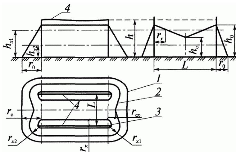
Рисунок 12. Схема зоны защиты двойного тросового молниепомехи: 1, 2, 3 - границы зон защиты на уровнях соответственно земли и высоты защищаемого сооружения; 4 - трос
